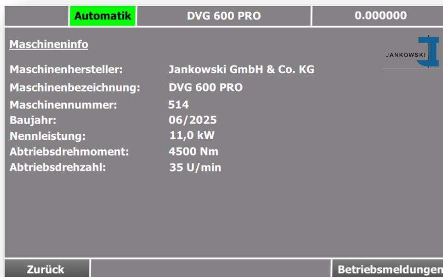
In diesem Untermenü werden technische Informationen wie Maschinenummer, Baujahr etc. zur vorhandenen Maschine angezeigt.
