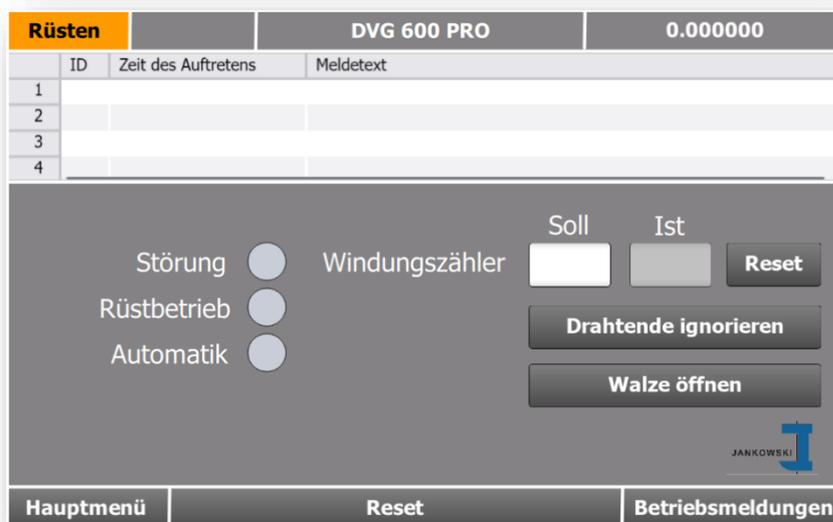
Im Rüstbetrieb wird im Startbildschirm neben der Ampel ein Windungszähler dargestellt. Hier kann eine gewünschte Anzahl Windungen (weißes Feld) eingestellt werden, die beim Einrüsten der Maschine erreicht werden soll.
