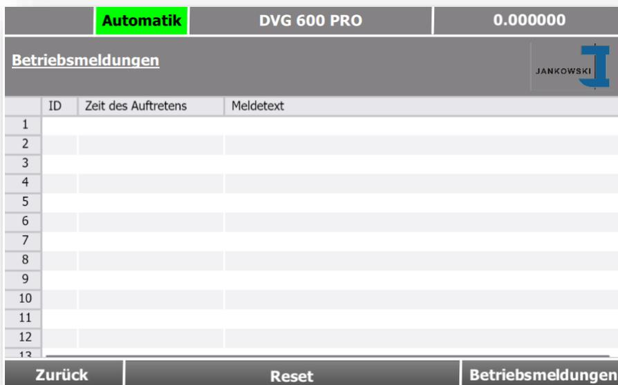
Es wird zwischen Störmeldungen und Betriebsmeldungen unterschieden. Störmeldungen werden rot hinterlegt und müssen nach Beseitigung quittiert werden. Betriebsmeldungen sind gelb hinterlegt und werden automatisch quittiert, sobald der erforderliche Betriebszustand erreicht ist.
