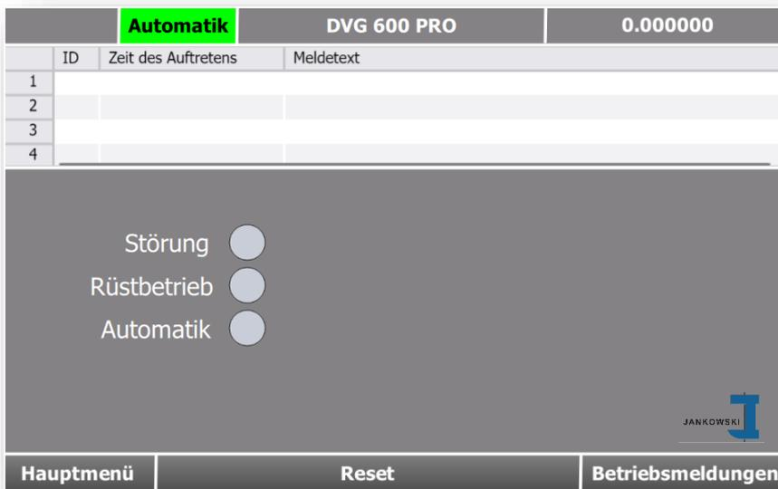
Im linken Bildschirmbereich wird Ihnen über ein Ampelsystem signalisiert, in welchem Betriebszustand sich das Gerät derzeit befindet.
