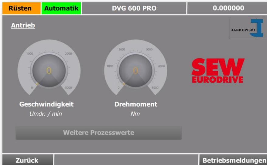
In diesem Untermenü werden antriebsseitige Informationen (Drehzahl / Drehmoment) zur vorhandenen Maschine angezeigt.
